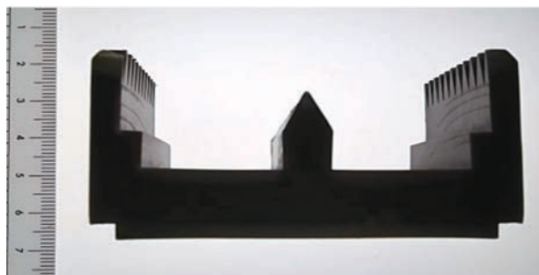
写真1 ひけ・反り無しの光成形品 (PP樹脂:肉厚12mm)
