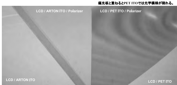
図4 ARTON ITOの光学均一性とPET TOの光学不均一性
