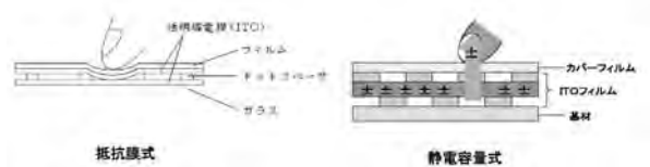
図1 タッチパネルの動作原理
