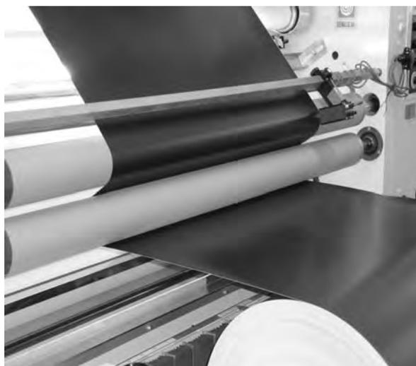
図8 NSG400の超鏡面外観
