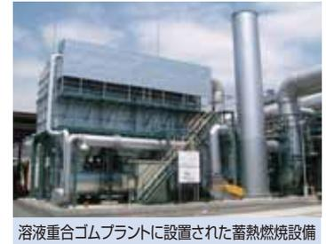
溶液重合ゴムプラントに設置された蓄熱燃焼設備
