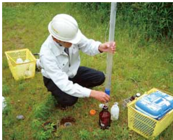
観測井戸での地下水調査
