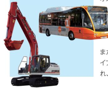
ブレーキ動作によって発生するエネルギーを電気エネルギーとして回収・蓄積するためにリチウムイオンキャパシタが使われます。パワーショベルなどの建設機械に実装され、旋回ブレーキエネルギーを蓄えて旋回加速時に再利用しています。また、欧州では2013年度にハイブリッドバスで実証試験が行われ、現在は実用化されています。
