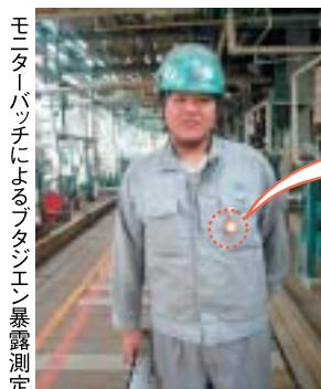
モニター パッチによるブタジエン暴露測定
