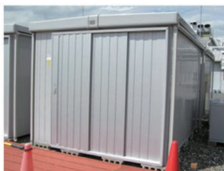
図5 プレハブ倉庫の屋根にSIFCLEAR ® ベースの遮熱塗料を塗工した実証実験の様子
