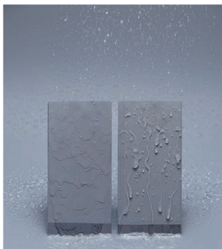
図4 塗料表面の水シャワーに対する挙動比較(左:SIFCLEAR ® ベース塗料, 右:一般フッ素系塗料)
