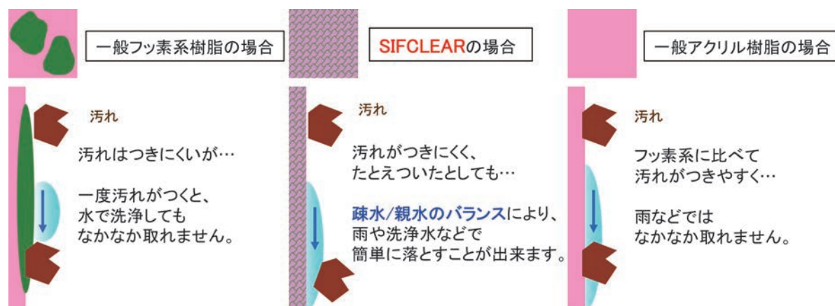
図3 SIFCLEAR®ベース塗料の防汚性メカニズム(汚れが付着する塗膜最表層の比較)
