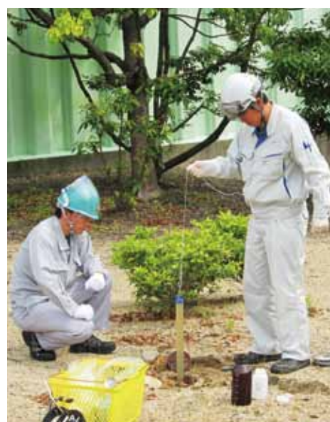
観測井戸での地下水調査
